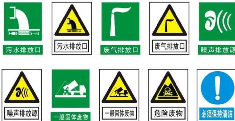
规范化排污口的有关设置（如图形标志牌、计量装置、监控装置等）属环保设施，排污单位必须负责日常的维护保养，任何单位和个人不得擅自拆除，如需变更的须报环保部门同意并办理变更手续。
