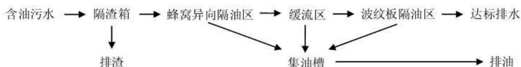
图 7-6 含油污水处理流程
