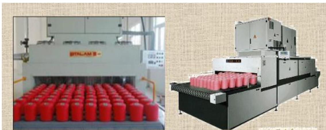
图 3-5 射频烘干机（示例，图片来自互联网）
