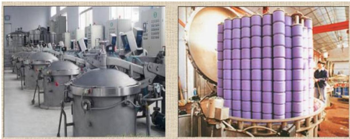
图 3-3 筒子染色机（示例，图片来自互联网）
