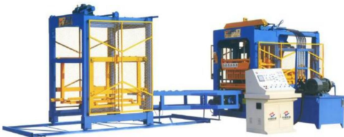
图 4-1 一体化自动免烧砖成型机
